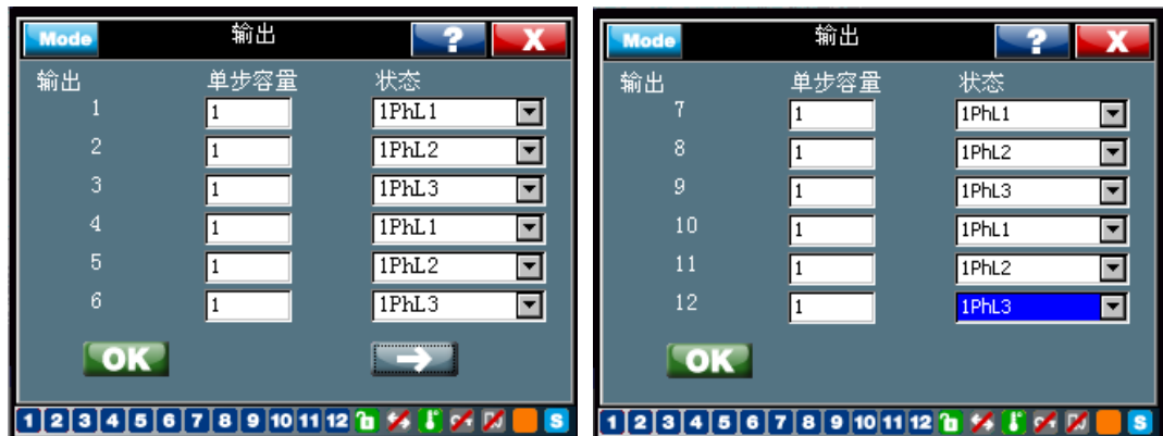
图 30: 典型输出端设置 12 x 1ph (RVT12-3P 三相型号)
